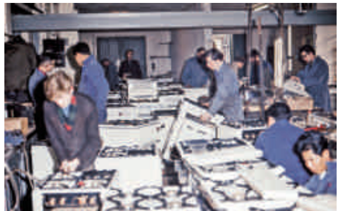
1966 werden über 20.000 Gasgeräte in nur vier Monaten entweder vor Ort beim Kunden oder in der Umbauwerkstatt der Stadtwerke auf Erdgas umgestellt.
